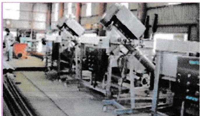
スクリューコンベアで使用するスクリュー羽根の種類は、多種多様にございます、ご使用の用途によって一から羽根を設計いたします。写真は、傾斜スクリューコンベア
